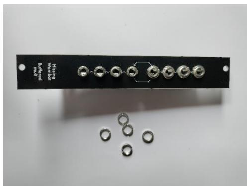
Als letztes schrauben Sie die Muttern auf die Anschlüsse, um das Front-Panel zu fixieren.
